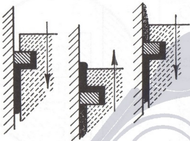
Fig. 85 - Se i segmenti hanno un accentuato gioco assiale, il consumo dell'olio diviene assai forte, perchè pistone e segmento funzionano come una piccola pompa aspirante-premente.
