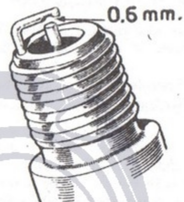
Fig. 35 - La distanza fra le punte delle candele deve essere di 0,6 - 0,7 mm. Poichè le punte si consumano è necessario provvedere di tanto in tanto alla regolazione della loro distanza, agendo però esclusivamente sull'elettrodo di massa (in figura, quello consumato).
