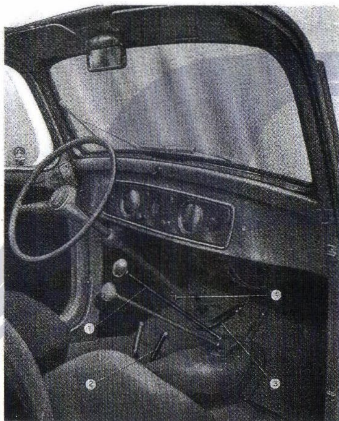
Fig. 18. - Posizione dei comandi all'avviamento della vettura.
