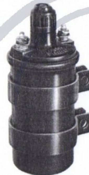
Fig. 13 - Bobina d'accensione Magneti Marelli per motocicli con motore a uno o a due cilindri.
